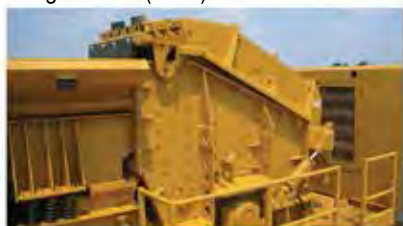
Trituradora de Impacto 5256T con Tapa de trituradora levantada
