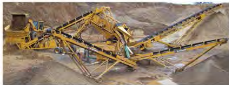
La planta de lavado Developer vista aquí tiene una criba 1,5mx3m (5'x10') de 3 niveles con tuberías para rociar, tornillo para arena de 1,1m (44"), un transportador de 24,4m (80') y dos de 12,2m (40') procesando cuatro tamaños de áridos lavados
