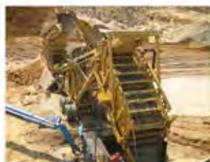
Planta Developer con criba de parrillas y barras de aspersores opcionales
