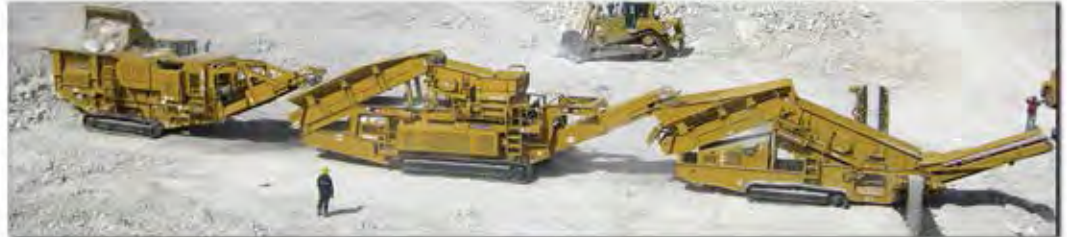
Combinación de planta completa con una Mandíbula JHT, Cono CST & Spyder 516T
