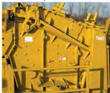
Trituradora de Impacto 4043T con tapa levantada
