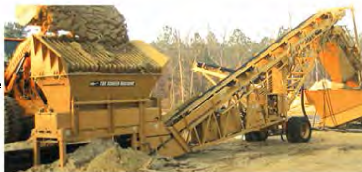
Producer con una criba 1,2mx2,4m (4'x8') de dos niveles en configuración de lavado con un tornillo de 0,9m (36") y dos transportadores de 12,2m (40')
